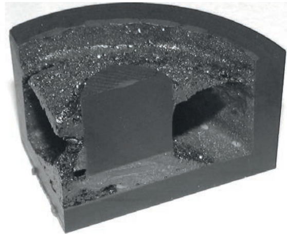
Rys. 5. Zdjęcie przekroju tygla po chemicznym wytrawieniu krzemu. Na środku widoczny jest fragment grafitowego walca do którego mocowane były zarodki. Kształt polikrystalicznego SiC odzwierciedla rozkład temperatur w tyglu – krystalizacja następowała w najchłodniejszych miejscach układu.
